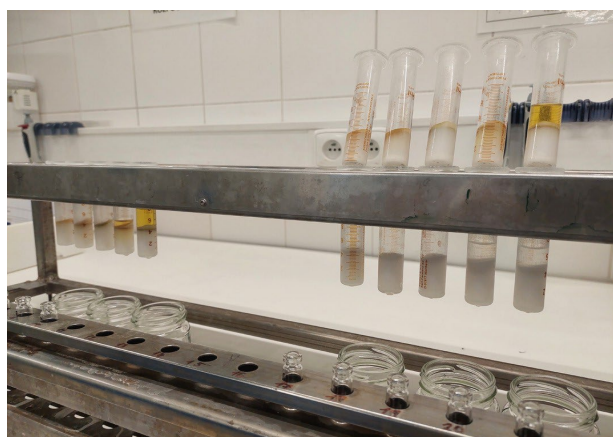
Figura 2: Sistemi a colonna e a doppia colonna per la purificazione degli estratti prima della determinazione degli Idrocarburi C10-C40.
