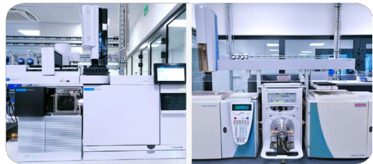
Figura 4: Strumentazione GC-MS/MS e GC-HRMS utilizzata per le analisi dei PBDD/F
