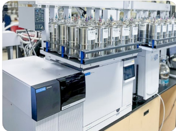
Figura 5. Strumentazione GC-MS/MS automatizzata per OTM-50
