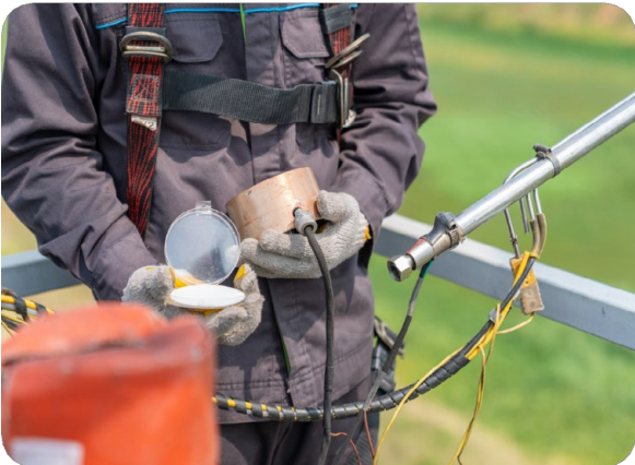
Figura 4. Campionatore da campo che assembla la sonda di campionamento e il filtro di ingresso per il campionamento con contenitore OTM-50
