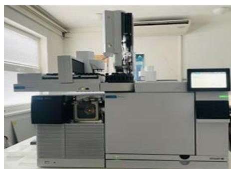
Figura 4: Strumentazione GC/MS/MS (QqQ) utilizzata per l'analisi dei PCN.
